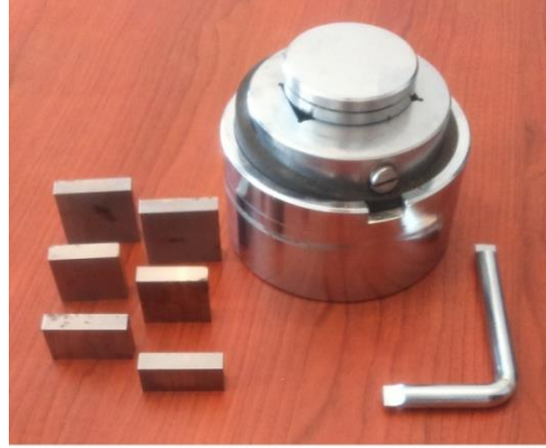
Şəkil 2.6.2. Yarımsəffaf tablet şəklində oksidlərin alınmasında istifadə olunan pressformanın görünüşü
